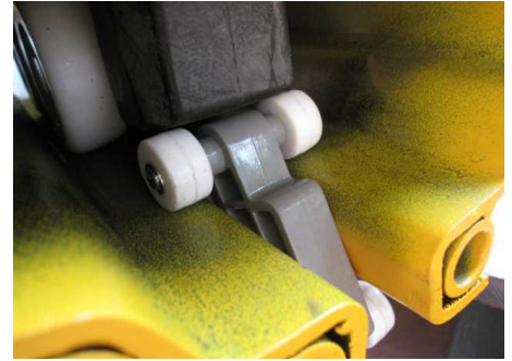
YTH-150がトロリのゴムバッファとの間にはさまり、動きが重くなった状態
