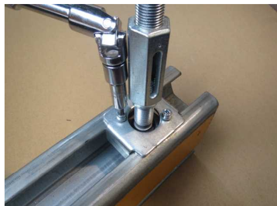
HB110S プロファイルコネクションのボルト 取付 (ユニバーサルジョイント使用)
