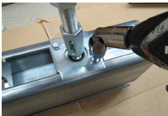
HB150S プロファイルコネクションのボルト 取付 (ユニバーサルジョイント使用)
