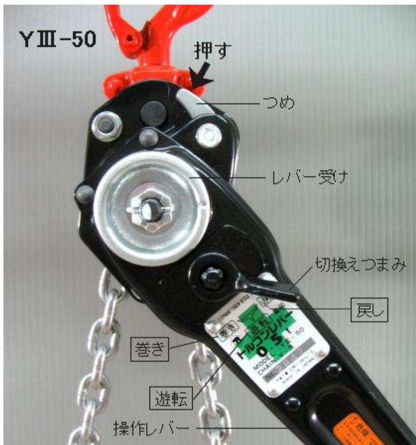
巻上げは切換えつまみを巻きにし、巻下げは切換えつまみを戻しにして操作レバーを操作すれば巻上げ巻下げが出来ます。
