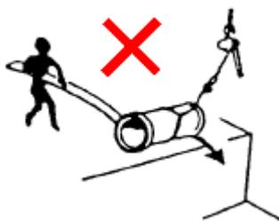
わずかな高さでも、荷がガタンと落下するのをレバーホイストで支えさせることはやめてください。ショックを与えると荷重を超える負荷がレバーホイストや他の玉掛け用具にかかり破損したり変形したりしますので、しないでください。ショックが激しい場合には荷が軽くても大変危険です。
