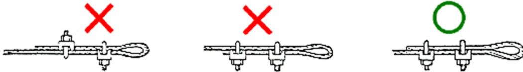
図6 ワイヤクリップの正しい使い方(○印)
