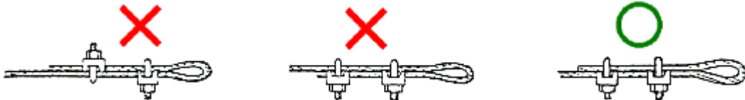
図6 ワイヤクリップの正しい使い方(○印)
