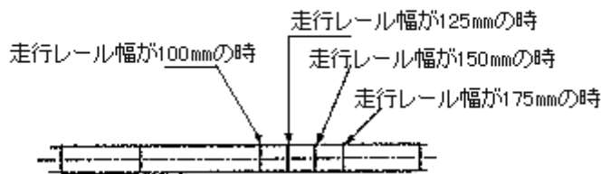
図46 連動軸のスナップリング位置
